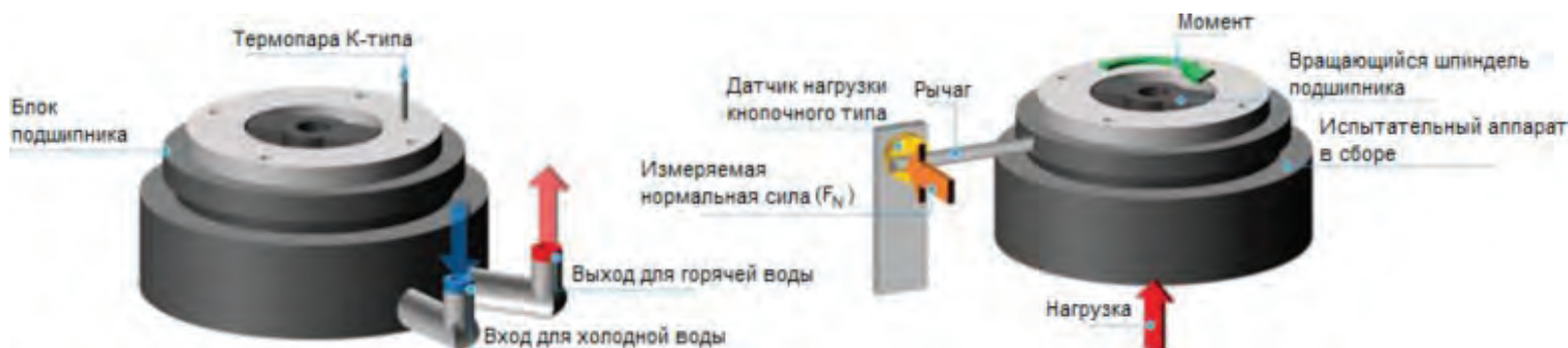
Рис. 3. Блок подшипника Ducom KRL в сборе с термопарой и системой циркуляции воды
