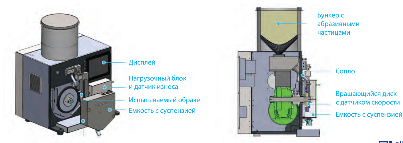
Схематичное изображение абразиметра DUCOM
