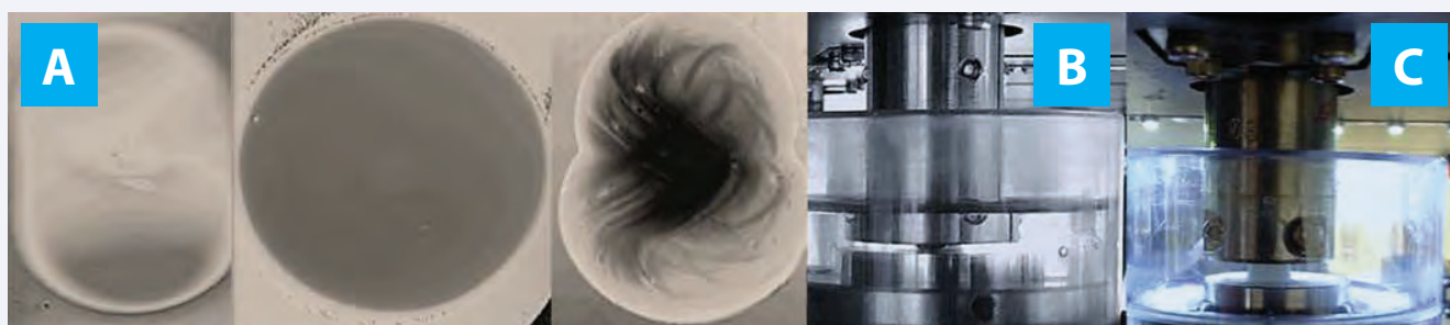
Профили износа: линейный, циркуляционный, бабочкой на материале UHMWPE
